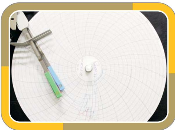
Los instrumentos críticos del par tiempo/temperatura que regulan el proceso estarán sometidos a un programa de mantenimiento y calibración.
